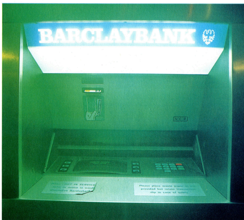
Verbreitet ist die Verwendung von Magnetkarten bei Bargeldautomaten. Der Magnetstreifen auf der Karte enthält eine Codenummer, die elektronisch gelesen und mit den Ziffern verglichen wird, die der Benutzer eintastet. Stimmen die Zahlen überein, wird der Zugang zur Geldausgabe freigegeben.
